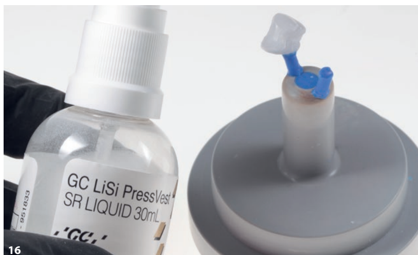
Abb. 14 Einbringen des Schraubkanals in die Wachskrone mithilfe des Parallelfräsges. Abb. 15 Vestibuläre und okklusale Reduzierung der Wachskrone um 0,2 bis 0,3 mm für eine individuelle Gestaltung mit Verblendkeramikmassen. Abb. 16 SR-Liquid reduziert laut Hersteller die Reaktionsschicht auf dem Pressobjekt. Die Restauration wird dünn mit dem SR-Liquid eingesprüht und Überschüsse vorsichtig verblasen.
